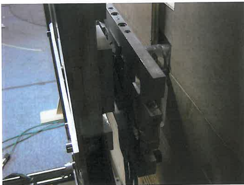
Figure 6 : Montage rigide de la maquette de la ventelle n°13 sur des balances dynamométriques placées dans les flasques du banc dynamique pour la mesure des efforts moyens.
