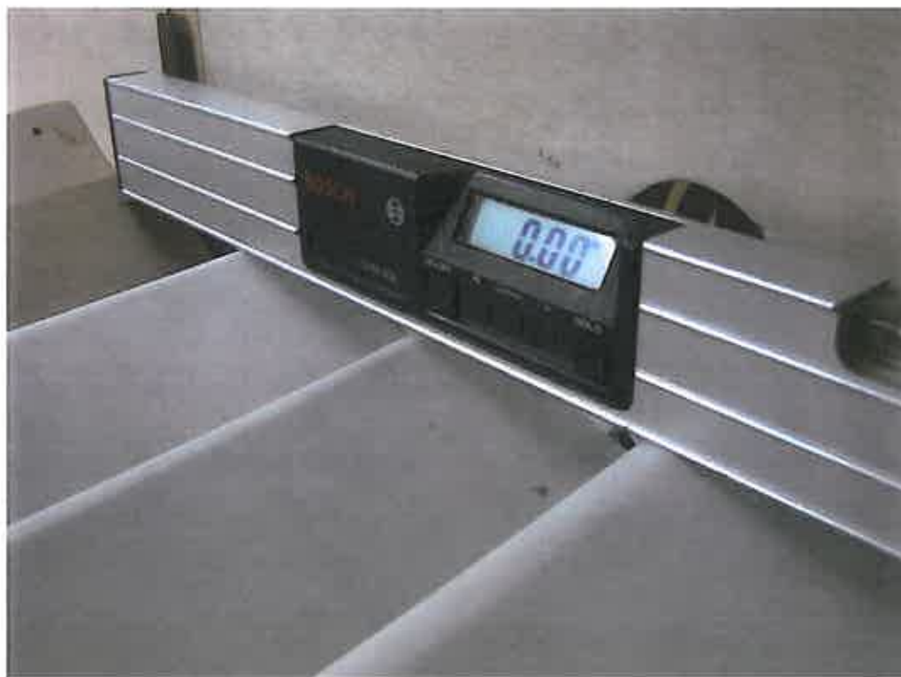
Figure 11 : Réglage précis de l'incidence avant et après chaque série d'essais
