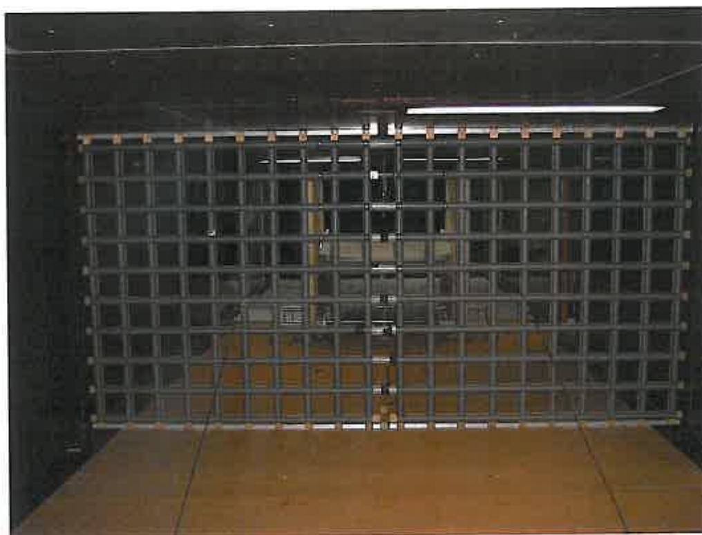
Figure 7 : Grille générant une turbulence homogène dans la veine d'essais Etude en soufflerie des actions du vent sur les ventelles de la Canopée des Halles de Paris
