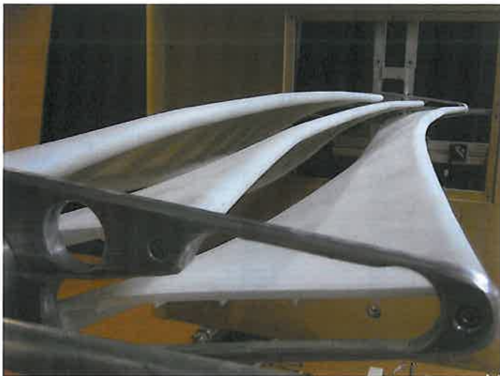
Figure 3 : Maquette sectionnelle des 3 ventelles en veine
