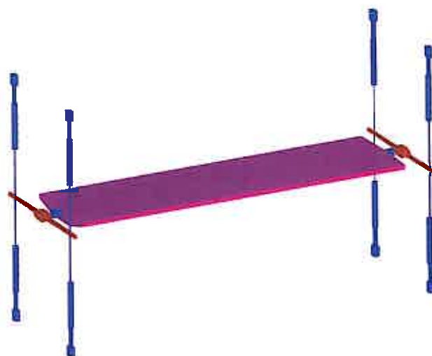
Figure 1 : Principe de la maquette sectionnelle suspendue
