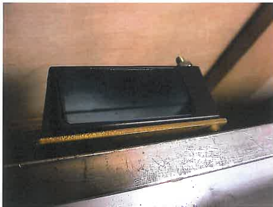
Figure 10 : Capteur laser mesurant le déplacement vertical de la maquette
